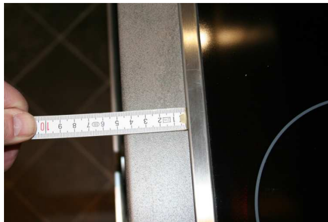
Tolerance på forkantplacering og vask og kogeplade foretages med tommestok.
