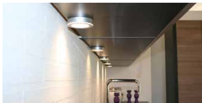
Spot monteres maksimalt 10 mm fra bagkant af skab
