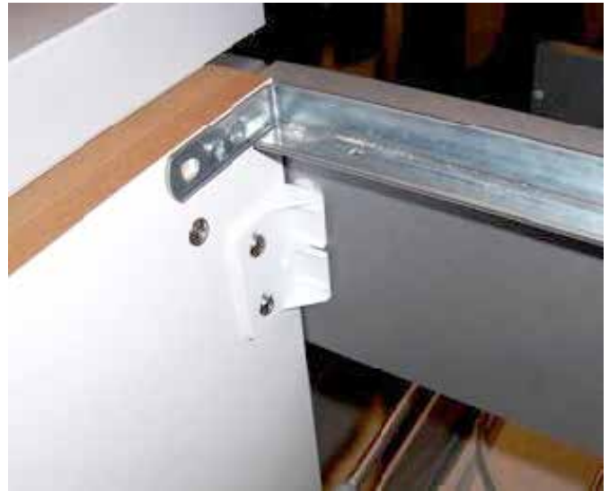
Bærestykke er monteret i de forborede huller.
